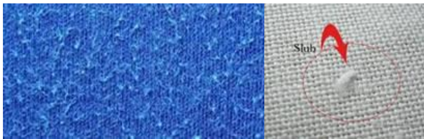
รูปที่ 2-25 ปุ่มบนบนเส้นใย (slub) หรือขน (pilling)
